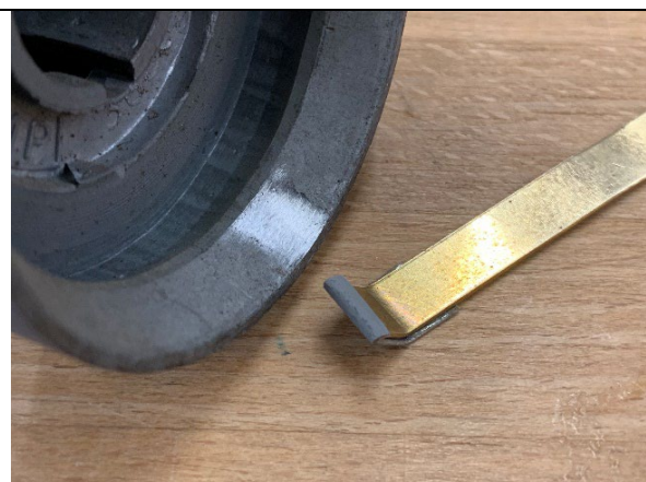
Fig. 31 : exemple de polissage effectué avec l'outil artisanal © Lionel Riva, HE-Arc, 2022
