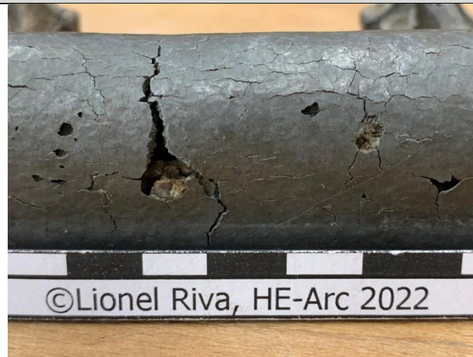
Fig. 83 : réseau de fissures sur l'ensemble de la parte en alliage de zinc de l'objet 17
