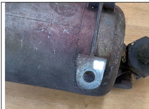
Fig. 30 : exemple de polissage effectué sur une surface non-visible au montage de la pièce © Lionel Riva, HE-Arc, 2022
