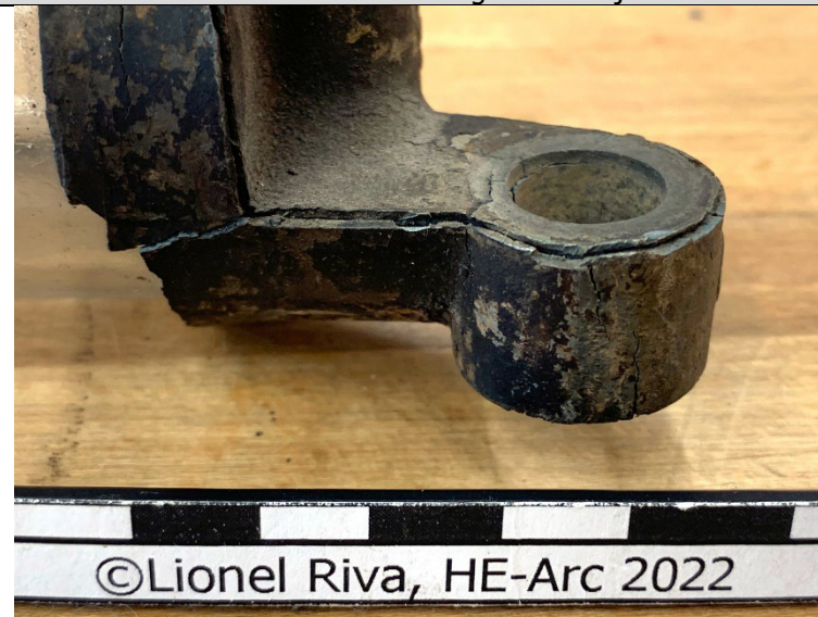
Fig. 79 : fissures transversales et déformation sur la partie supérieure du distributeur N°6
