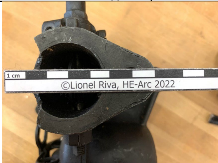
Fig. 78 : réseau de fissures sur le corps du distributeur N°6
