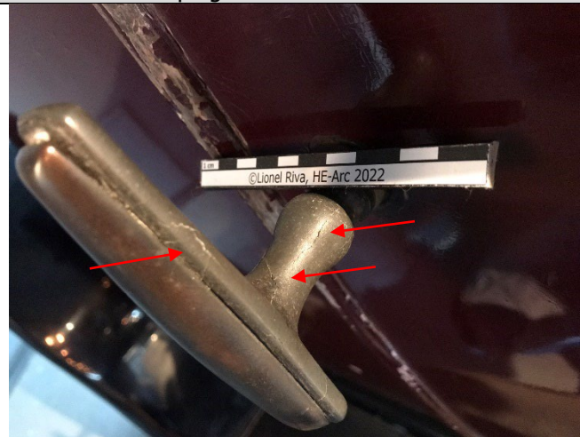
Fig. 4 : Peste du zinc sur poignées intérieures Delage Type D6-11
