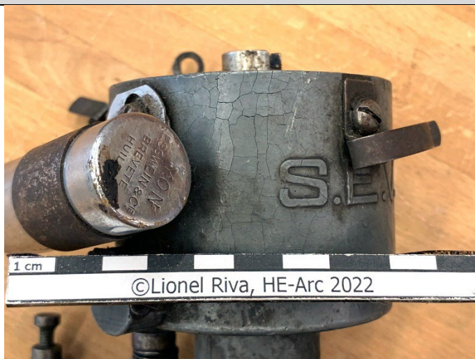
Fig. 78 : réseau de fissures sur le corps du distributeur N°6
