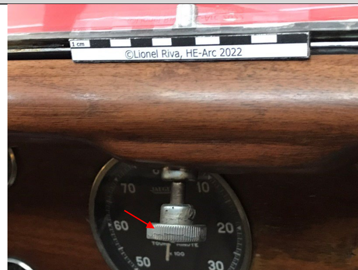
Fig. 8 : Peste du zinc sur commandes de tableau de bord Bugatti Type 57C
