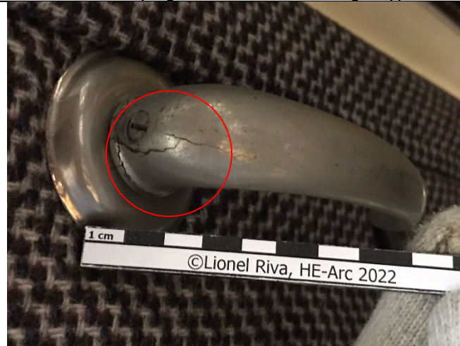
Fig. 4 : Peste du zinc sur poignées intérieures Delage Type D6-11
