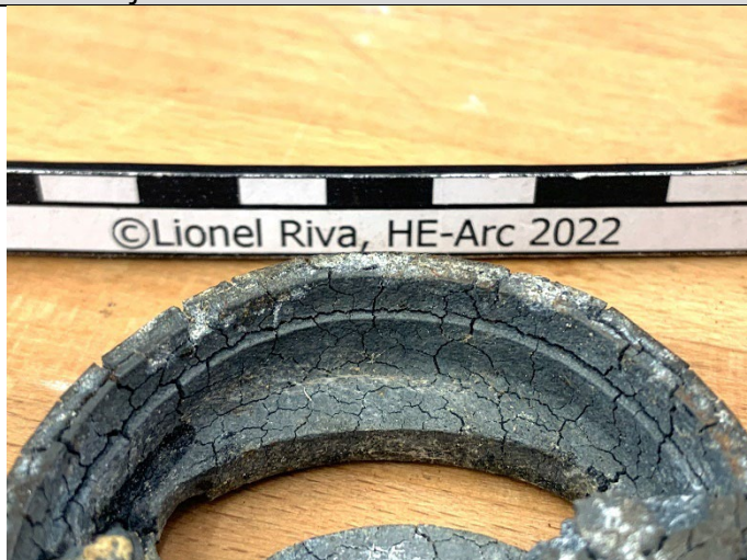
Fig. 82 : Fissure transversale sur l'angle interne et réseau de fissures sur l'ensemble de l'objet 14
