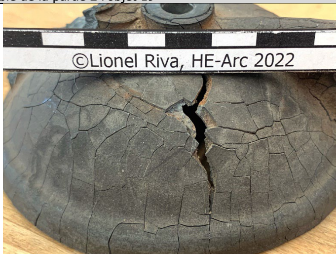
Fig. 86 : réseau de fissures sur l'ensemble de l'objet 20
