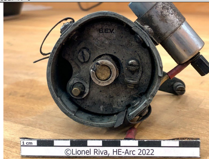
Fig. 79 : fissures transversales et déformation sur la partie supérieure du distributeur N°6
