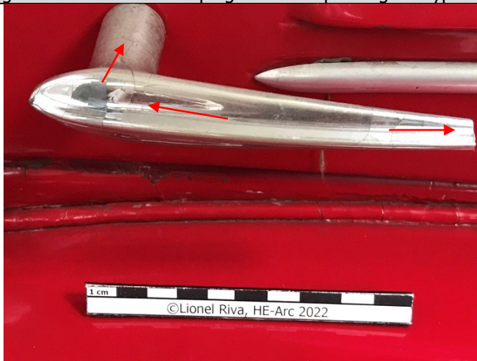
Fig. 9 : Peste du zinc sur poignées de capot Bugatti Type 57C
