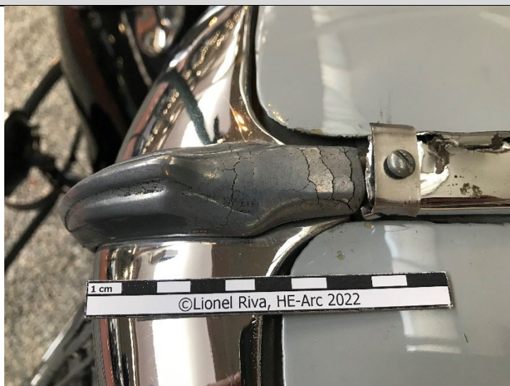
Fig. 7 : Peste du zinc sur garniture de radiateur Citroën 7A
