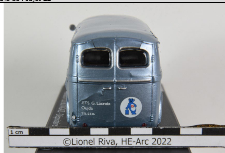
Fig. 87 : Réseau de microfissures supposé en raison des légères déformations sur toit et décollement du revêtement de surface sur le toit, le coffre et le côté gauche de l'objet 22
