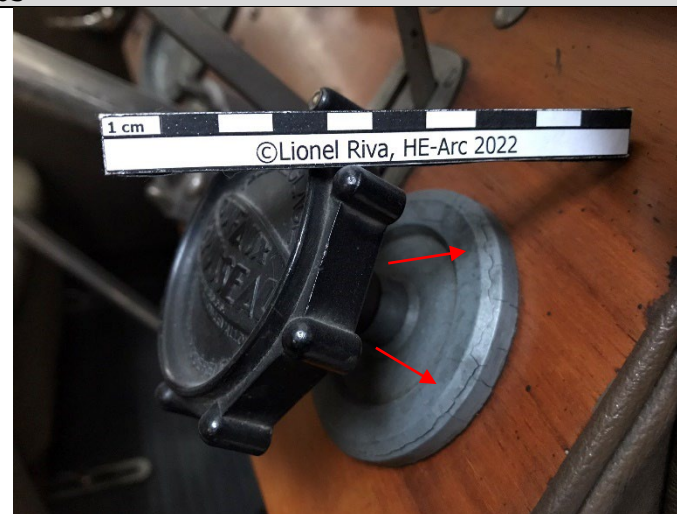
Fig. 8 : Peste du zinc sur commandes de tableau de bord Bugatti Type 57C
