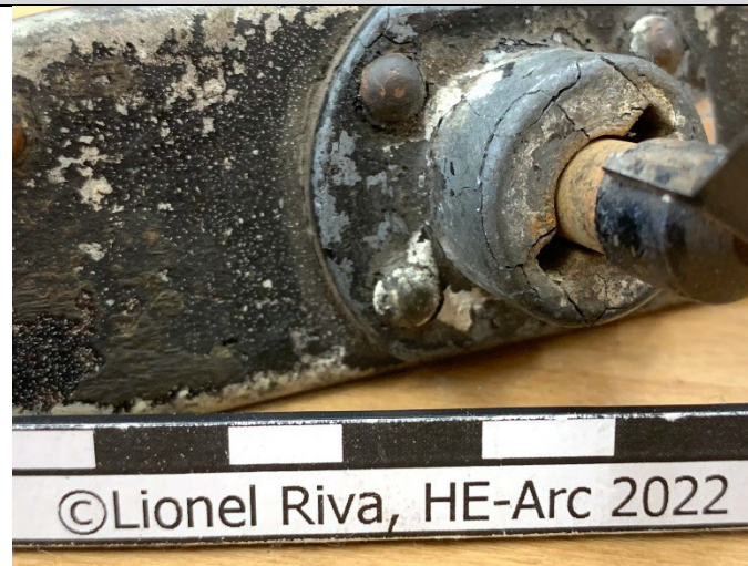
Fig. 83 : réseau de fissures sur l'ensemble de la parte en alliage de zinc de l'objet 17
