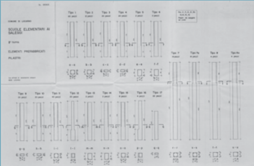
Figura VIII d. Ufficio di Ingegneria Maggia, Elementi prefabbricati, pilastri, s.d. (AIMME). Gli elementi prefabbricati, progettati ad hoc in collaborazione con lo Studio di Ingegneria Maggia di Locarno, comprendono pilastri, travi, travi speciali, solette, palconcelli, montanti e architravi di finestre, parapetti, cornicioni, zoccoli, ecc. Per ogni elemento sono previste numerose varianti: per esempio, sono disegnati diciassette tipi diversi di pilastri, di diverse altezze e sezioni, con uno, due o tutti gli angoli smussati.
